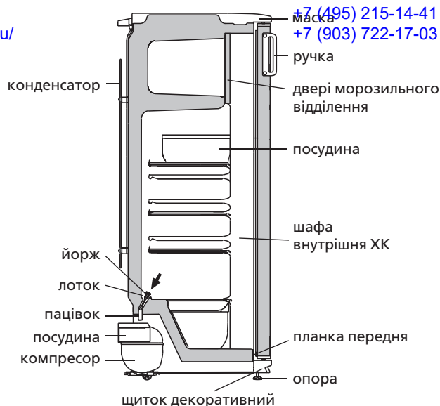
Рисунок 4 – Схема зливу талої води із ХК
